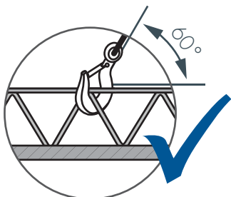
Obr. A.1, Najmenej 3 styčniky od začiatku priehradového nosníka
